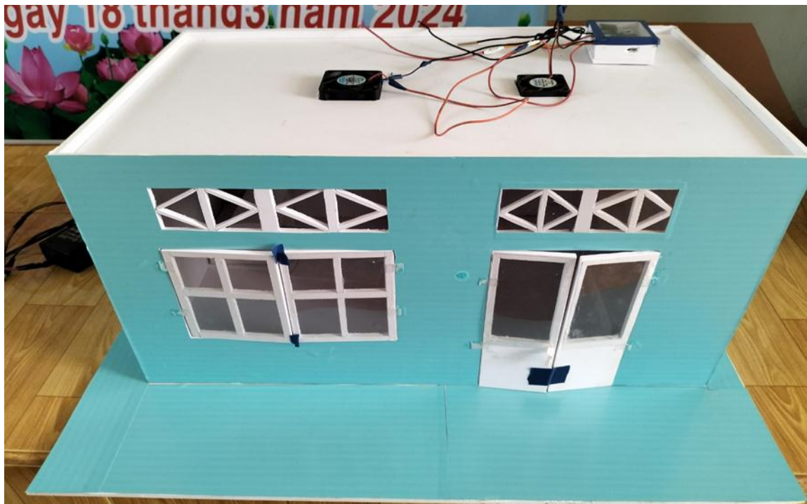
Hình 5. Trần phòng học được lắp hệ thống quạt và mạch điều khiển.
